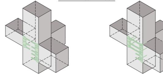
Per i moduli con H pari a 200 o 300 mm, nel caso di pilastri con larghezza maggiore di 50 cm, è necessario applicare anche le PROLUNGHE VERTICALI PV.
