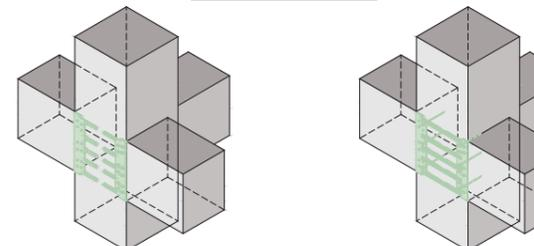
Per nodi con travi asimmetriche il sistema si ottiene mediante l'assemblaggio dei MODULI F di differenti altezze ciascuno pari all'altezza pertinente alla rispettiva trave.
