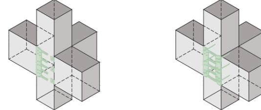
Per nodi con dimensioni in pianta del pilastro maggiori o uguali a 40 cm il sistema si ottiene dall'assemblaggio dei MODULI F e delle PROLUNGHE P. Il collegamento tra moduli e prolunghe è effettuato mediante l'inserimento di 2 bulloni M8 cl. 8.8 (II) in corrispondenza di ciascuna flangia (III). Nel caso in cui la larghezza del nodo non sia modulare al passo dei fori delle flange, è necessario centrare la composizione del sistema rispetto al pannello nodale.
