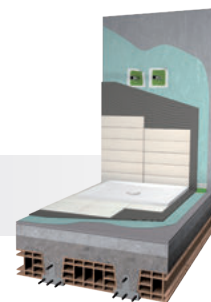
POLAGANJE KERAMIKE NA CEMENTNE PODLAGE IN MAVČNO-KARTONSKE PLOŠČE V VLAŽNIH PROSTORIH IN TUŠIH
