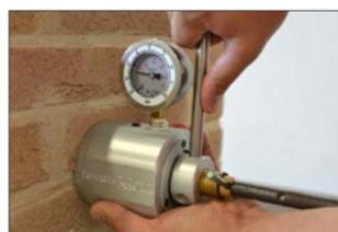
UTILIZZO DELL'ESTRATTORE CERTIFICATO DI KERAKOLL SPA PER LE PROVE PULL-OUT IN CANTIERE PER LA VERIFICA DELLA TENUTA DELLE BARRE ESISTENTI
