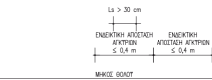
ΚΑΤΟΨΗ ΕΝΙΣΧΥΣΗ ΜΟΝΑΣΤΗΡΙΑΚΟΥ ΘΟΛΟΥ ΜΕ ΙΝΟΠΛΕΓΜΑΤΑ GEOSTEEL GRID 200/400 Ή RINFORZO ARV 100
