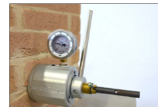
ΕΞΟΠΛΙΣΜΟΣ ΕΞΟΛΚΕΥΣΗΣ ΣΕ ΛΕΙΤΟΥΡΓΙΑ - ΕΛΕΓΧΟΣ ΤΗΣ ΑΠΟΔΟΣΗΣ ΤΩΝ ΡΑΒΔΩΝ
