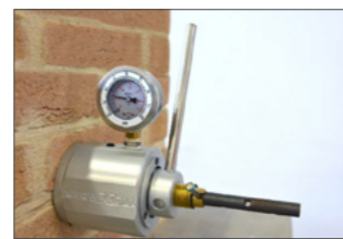
ΕΞΟΠΛΙΣΜΟΣ ΕΞΟΛΚΕΥΣΗΣ ΣΕ ΛΕΙΤΟΥΡΓΙΑ - ΕΛΕΓΧΟΣ ΤΗΣ ΑΠΟΔΟΣΗΣ ΤΩΝ ΡΑΒΔΩΝ
