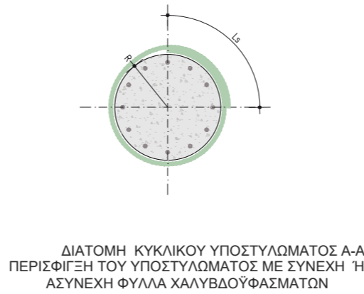
ΔΙΑΤΟΜΗ Α-Α' ΠΕΡΙΣΦΙΓΗ ΤΟΥ ΥΠΟΣΤΥΛΩΜΑΤΟΣ ΜΕ ΣΥΝΕΧΗ Ή ΑΣΥΝΕΧΗ ΦΥΛΛΑ ΧΑΛΥΒΔΟΥΦΑΣΜΑΤΩΝ
