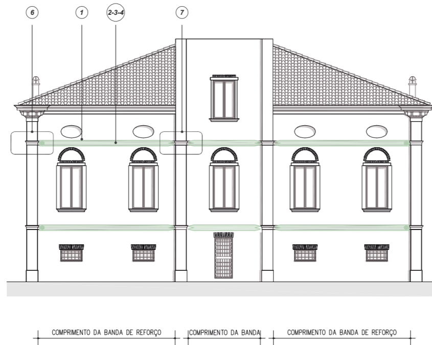
DETALHE A-A' REFORÇO DE PANOS DE PAREDE RESISTENTE COM BANDAS GEOSTEEL G600/G1200
