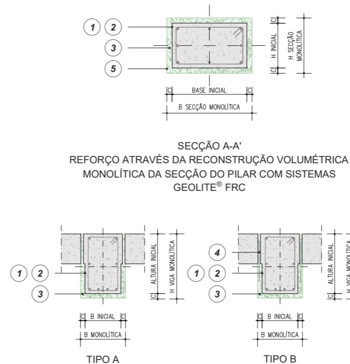
SECÇÃO B-B' REFORÇO ATRAVÉS DA RECONSTRUÇÃO VOLUMÉTRICA MONOLÍTICA DA SECÇÃO DA VIGA COM SISTEMAS GEOLITE® FRC
