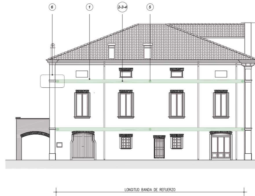
DETALLE B-B' REFUERZO DE PARTES DE EDIFICIO CON BANDAS DE GEOSTEEL G600/G1200
