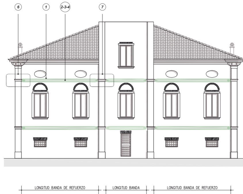
DETALLE A-A' REFUERZO DE PARTES DE EDIFICIO CON BANDAS DE GEOSTEEL G600/G1200
