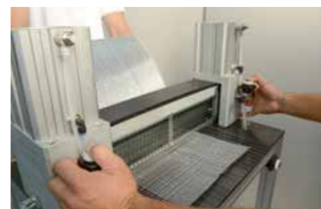
3 Plegado del tejido de fibra de acero GEOSTEEL.
