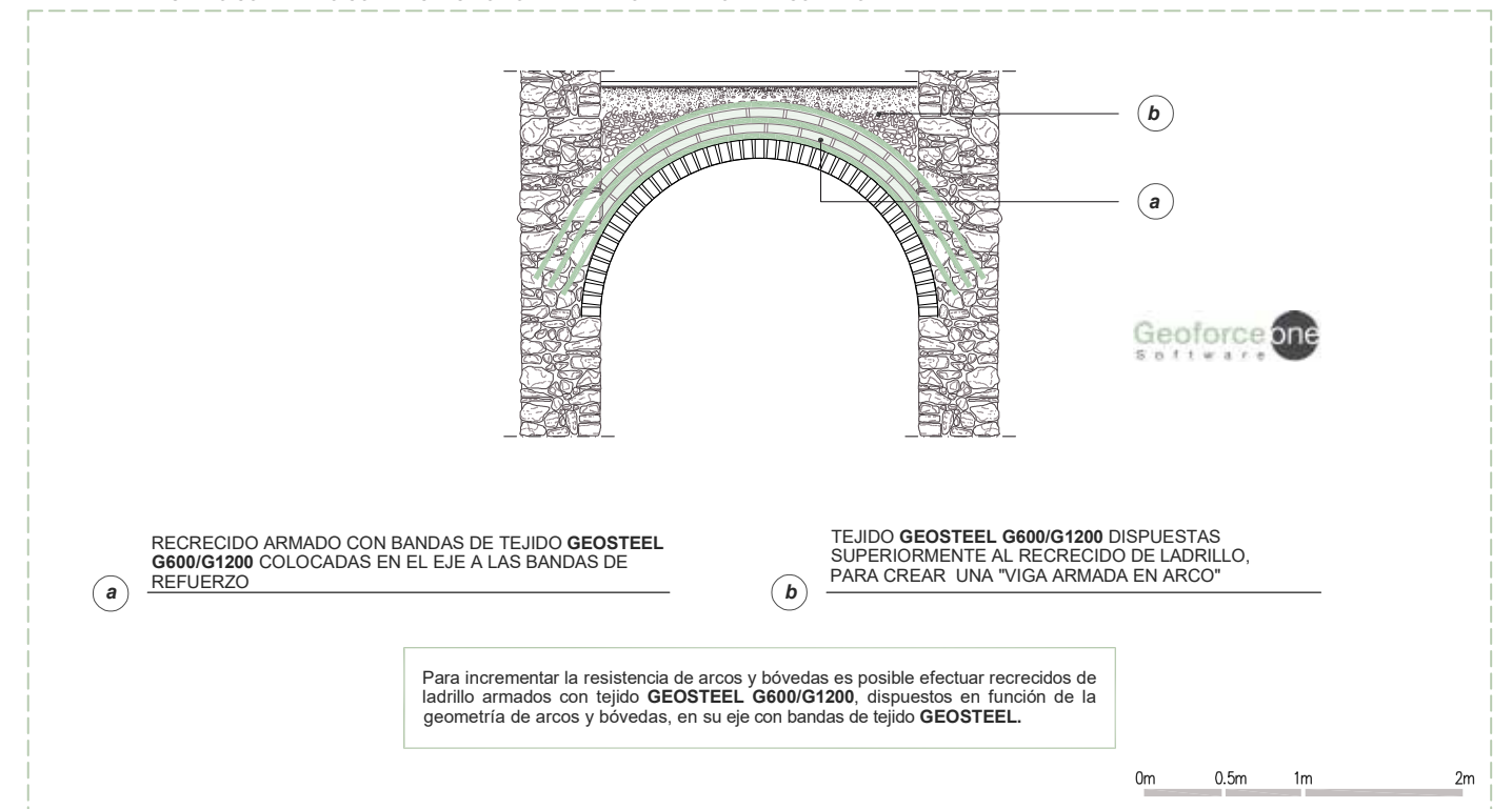
SISTEMA DE REFUERZO COMBINADO CON RECRECIDO POR EL TRASDÓS ARMADO DE ARCOS Y BÓVEDAS
