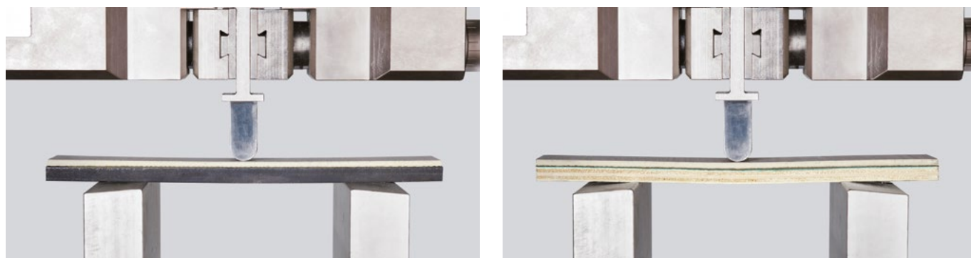
Prove di resistenza alla flessibilità.
