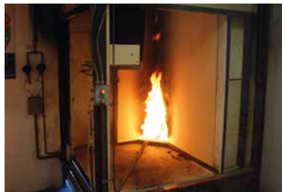
Δοκιμή Μεμονωμένου Καυγόμενου Αντικειμένου.
