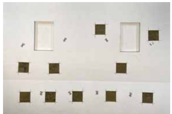
Δοκιμή πρόσφυσης μεταξύ υλικού λείανσης, επένδυσης με το μονωτικό υλικό.
