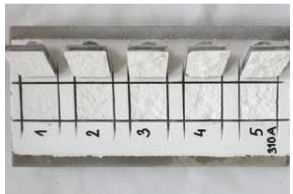
Δοκιμή πρόσφυσης με διάρρηξη του μονωτικού υλικού.
