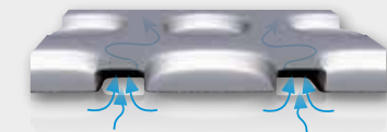
El volumen del espacio que define la cámara de aire permite la liberación de la tensión de vapor proveniente del soporte.
