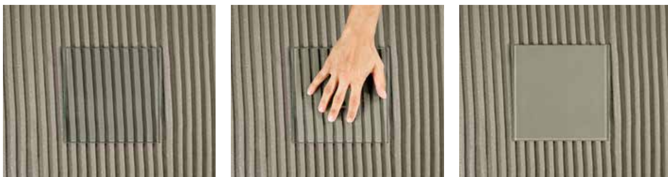
Ensaio de capacidade de molhagem com H40 Gel cinza. Com uma simples pressão, é possível obter o leito maciço debaixo do ladrilho.
