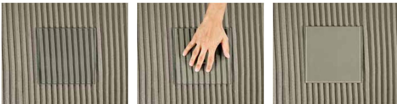
Tests de mouillage sur H40 Gel gris.
