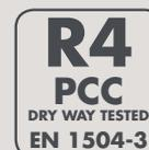
Geolite, dopo maturazione costantemente in acqua (CC - stagionatura sott'acqua a  $21 \pm 2$  °C) supera i requisiti imposti dalla EN 1504-3, Classe Strutturale R4: pertanto è utilizzabile nel ripristino e consolidamento di strutture in calcestruzzo armato che in servizio operano costantemente sott'acqua (canali, piscine, vasche, ecc.)
