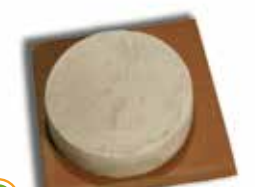
Φυσική Υδραυλική Άσβεστος - NHL διαστολή δοκιμίου \approx 10%
