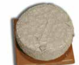
Φυσική Υδραυλική Άσβεστος - NHL διαστολή δοκιμίου \approx 10%
