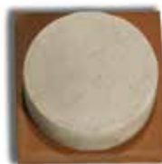
Φυσική Υδραυλική Άσβεστος - NHL διαστολή δοκιμίου \approx 10%
