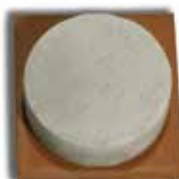
Τεχνητή Υδραυλική Άσβεστος - HL διαστολή δοκιμίου \approx 30%
