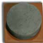
Τσιμέντο Portland διαστολή δοκιμίου \approx 40%
