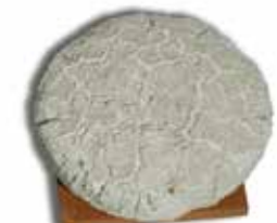
Τεχνητή Υδραυλική Άσβεστος - HL διαστολή δοκιμίου \approx 30%
