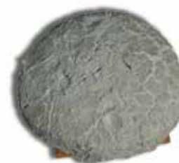
Τσιμέντο Portland διαστολή δοκιμίου \approx 40%
